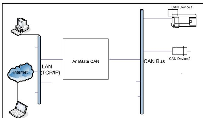
Die Anbindung an den CAN Bus über das Internet ist ebenso möglich, wie der zeitgleiche Zugriff von mehreren verschiedenen PCs über das Netzwerk. Über optional aufsteckbare USB-Sticks wird WLAN und WWAN unterstützt.
